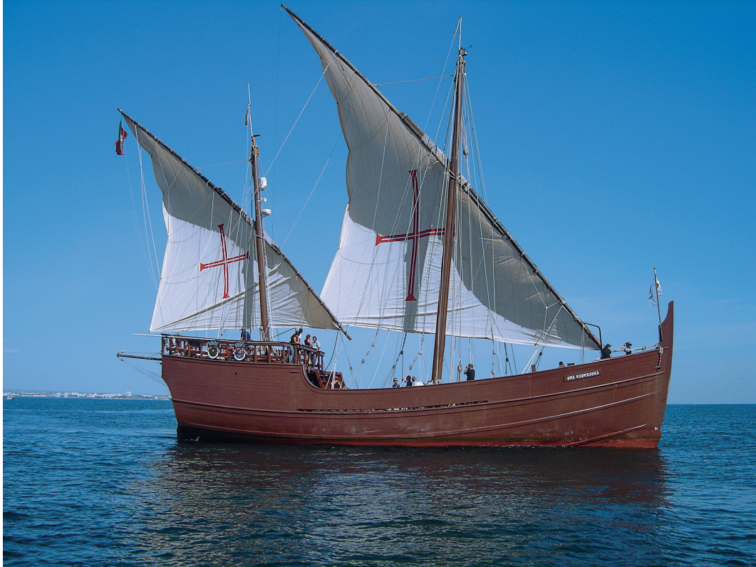
Abb. 2: Nachbau 2008 einer portugiesischen Karavelle aus dem 15. Jahrhundert. Masse: 12–18 m Länge, 5 m Breite, 1,5 m Tiefe. Besatzung: 20–25 Männer. Das dreieckige Lateinsegel und das Steuerruder Backbord erlauben das Segeln gegen den Wind.
